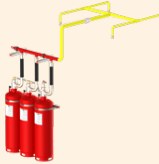
Типовая схема АУГП: группа модулей МПТХ2 в один ряд (фиксация к стене)
