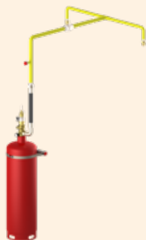
Типовая схема АУГП: один модуль МПТХ (Dу33 или Dу50)
