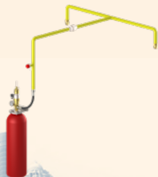
Типовая схема АУГП: один модуль МПТХ (Dу12)
